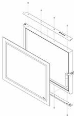
Rysunek 18. Demontaż i wymiana drzwi seria MB.
