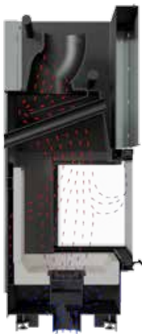
Rysunek 26. Schemat obiegu powietrza wewnątrz wkładów z serii NBC
