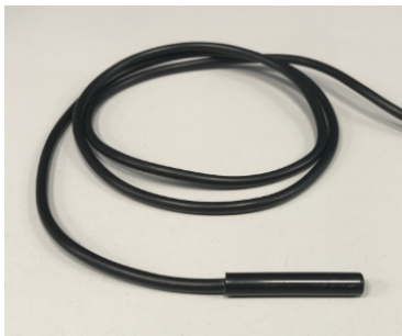
Dis. 7. Fuoriuscita del sensore di temperatura all'esterno: a) Smontaggio dello sportello di revisione, b) Sensore di temperatura
