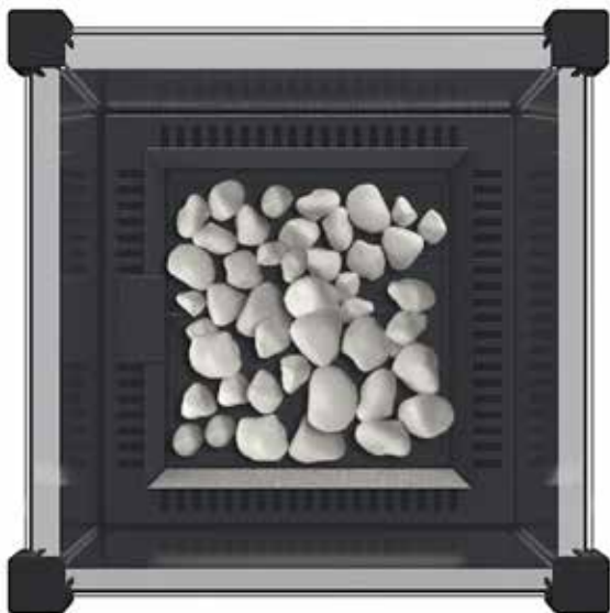
Rys.5. Prawidłowe rozłożenie kamieni ozdobnych na palniku.
